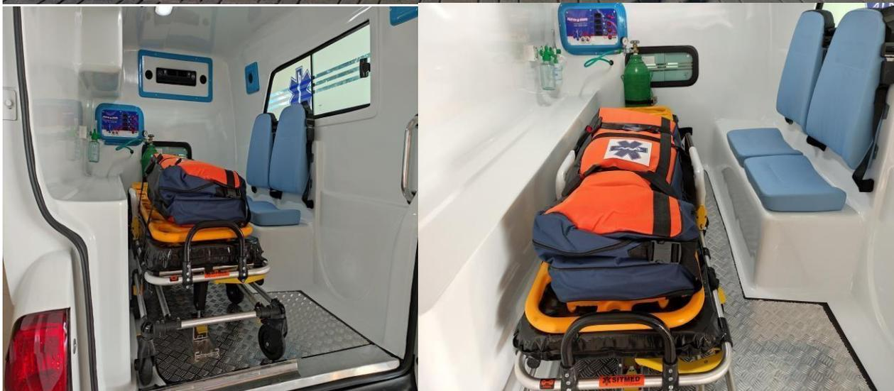
Como já dito, com Baú em **FIBRA DE VIDRO (PRFV)**, totalmente lavável e higienizável, característica impossível ao material exigido pelo edital (Alumínio). Incomparavelmente leve, aumentando a segurança, e diminuindo gastos com manutenção, em especial na parte de suspensão do veículo e desgaste dos pneus:
